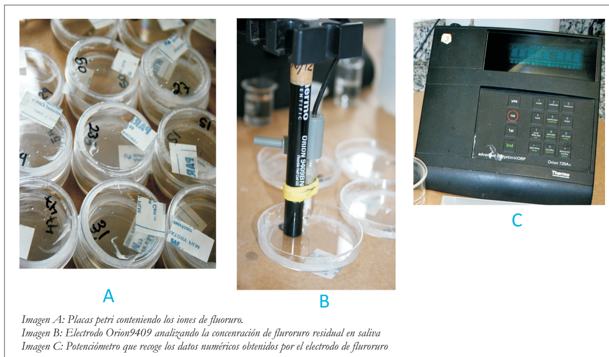
Fig.12 Secuencia metodológica de la evaluación de flúor en el laboratorio bajo el método de difusión de Taves y el uso del electrodo Orión 9409.
