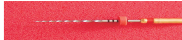
Figura 5. Foto de uno de los instrumentos utilizados 2 veces fracturado.
