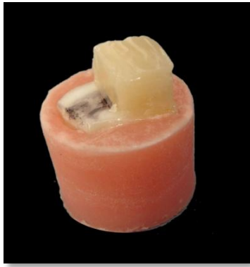
Figura 5. Aspecto de la muestra con la resina compuesta de nano-partículas (FiltekZ 350 XT - A2 Body- 3M ESPE) luego de haber recibido el tratamiento correspondiente a cada grupo de estudio.
