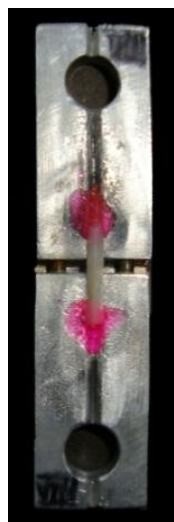
Figura 10. Probeta montada en el dispositivo metálico para ensayo de micro-tracción.
