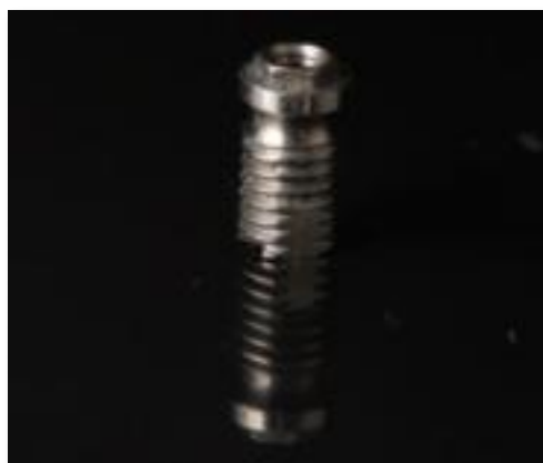
Fig. 37: Implante modificado con dos facetas antirotacionales y mas antes de ser cementado en la bandeja
