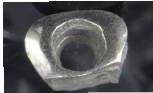
Fig. 33: Arandela autocentrante colada a medida con forma externa irregular para que no gire. Nótese la cuna para el total asentamiento del tornillo
