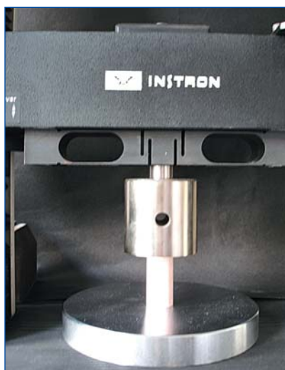
Fig. 2. Muestra posicionada en la máquina de ensayo universal Instron.
