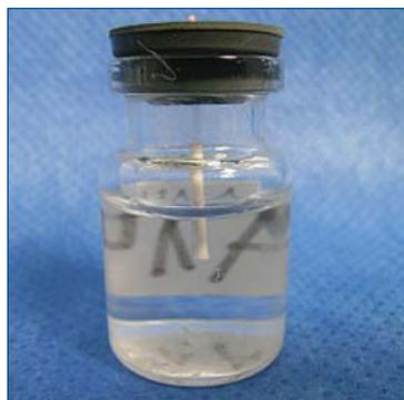
**Fig. 5.** Frasco con agua destilada y tubo capilar cargado y sellado.
