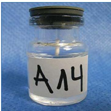
**Fig. 4.** Frasco con agua destilada y tubo capilar cargado y sellado.
