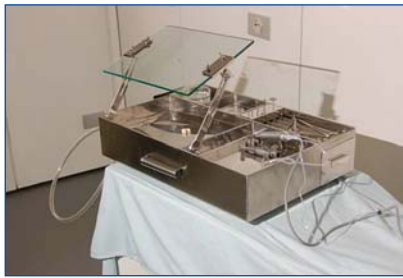
Fig. 13: Vista oblicua que muestra la caja preparada con el micromotor, las fresas, las cajas de Petri y el protector, listos para trabajar.
