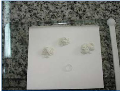
**Fig. 5.** Preparación de la mezcla con 3 partes de polvo y 1 parte de solución según instrucciones del fabricante.
