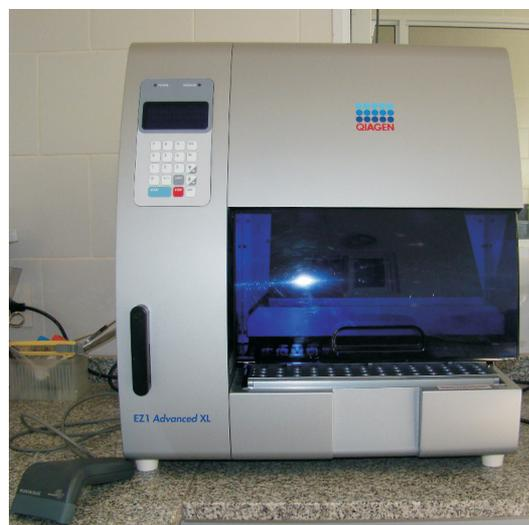
Fig. 6. Robot automático de extracción y purificación
